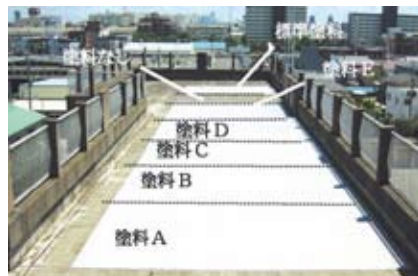
高反射率塗料の表面温度上昇緩和効果測定状況
